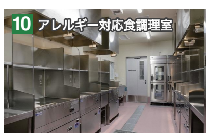
アレルギー専用の調理室を設け、より厳しい衛生環境で調理します。調理には大型の仕切り板を設けたシステム調理台を導入し、アレルギー物質の誤混入を防止します。
