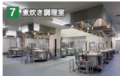
煮炊き釜は床に水がこぼれにくいエプロン付き。金側面は調理中も熱くない低輻射構造で作業性、安全性に優れています。
