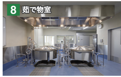
和え物調理前に野菜を茹でる専用室。煮炊き釜で大量の野菜を一度に茹でる事ができます。
