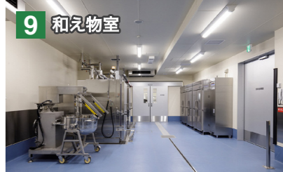
室温を低く抑えて安全に和え物調理。専用の攪拌装置と移動釜を連結して食材を均等かつ衛生的に攪拌。従来の手による攪拌と比べて大幅な省力化を実現します。
