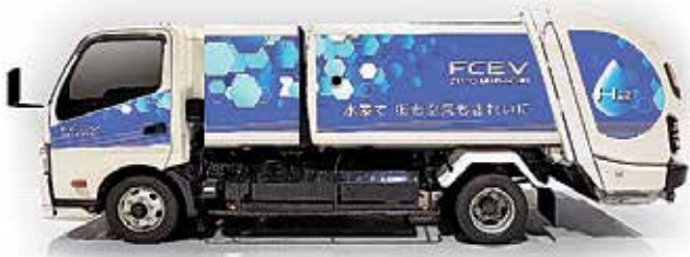
燃料電池ごみ収集車(イメージ) ※技術検討実証車 (スーパー耐久レース展示車両) 写真提供: トヨタ自動車株式会社
