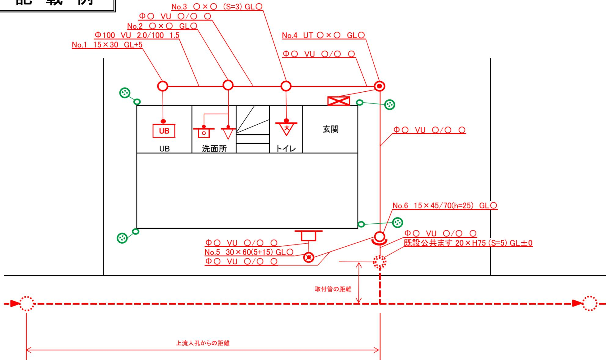
⊗ 雨水浸透ます  $\Phi \times \times$
