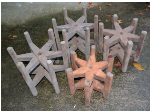
【写真2】熨斗糸を巻き取る糸枠
