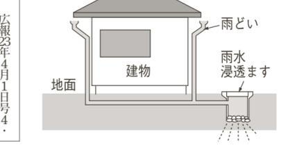
雨水浸透の仕組み: 雨水が建物や道路から地面に落ちると、浸透ますを通って地下にしみこみ、地下水を涵養(かんよう)します。
