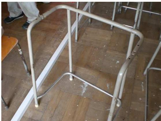
3 体重をかけながら、パイプのつながっていないほうを内側に折り曲げていき、完了図のようにする。
