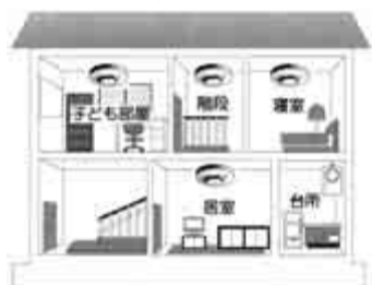
住宅用火災警報器の設置例
