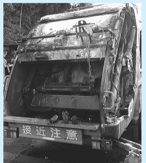
スプレー缶などが原因とみられる清掃車の火災
